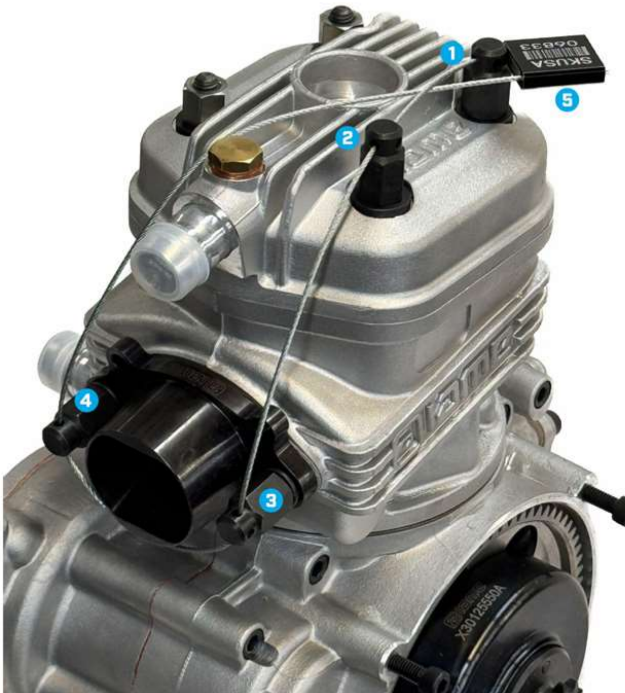
Instalación del sello del motor
